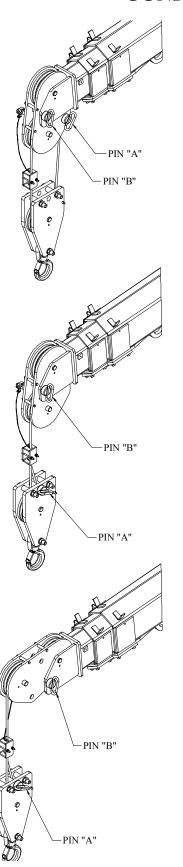
STANDARD 2 PART LINE SHEAVE FLIPPED DOWN CAPACITIES AS SHOWN ON LOAD CHART
