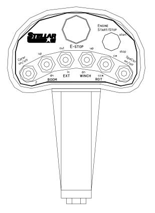
THIS CRANE IS OPERATED BY A RADIO CONTROL SYSTEM WHICH OPERATES AN ELECTRONIC VALVE BANK. THE CONTROLLER (AS SHOWN) OPERATES THE FOLLOWING FUNCTIONS:
